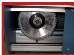
Sägeblatt in der Werkzeugwechselposition, mit Feststellbolzen
